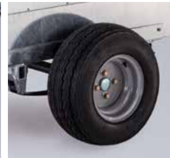
Q5/6/7e Gelände-Anhänger Flotation-Reifen (20,5 x 8-10)
